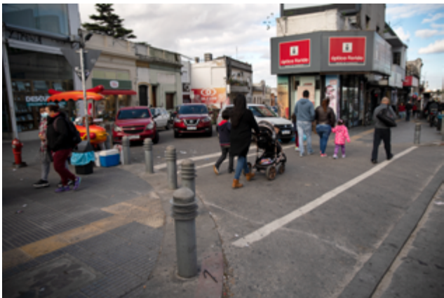
↑ Montevideo, Uruguay. Av. Agraciada, Paso Molino: veredas con rampas, pavimento podotáctil, cruces elevados y orejas. Imagen: Diego Battiste
